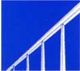
Viaducto de canto constante
