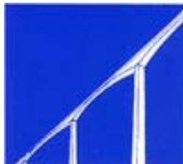
Viaducto de canto variable
